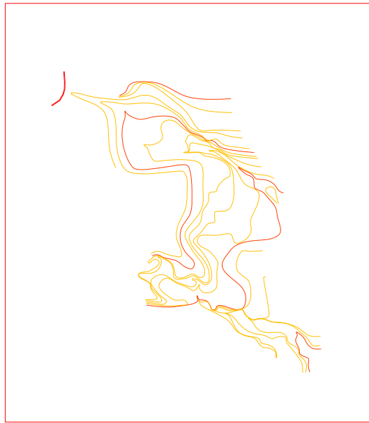
Gambar 4. Peta topografi lokasi calon embung dengan interval kontur per 1 meter
