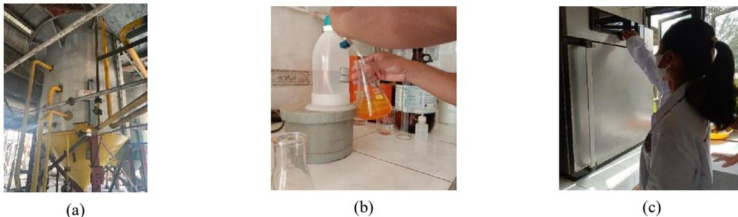
**Gambar 3. Sampel *Crude Palm Oils* diambil dari *Oil Tank* a) dan dilakukan perlakuan pendahuluan b) sebelum dilakukan titrasi c) dengan 0,1N NaOH dengan indikator *PhenolPhtalein* [6].**
