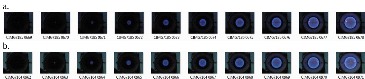
Gambar 2 Model perkembangan diameter nyala dari arak bali b. Model perkembangan diameter nyala dari etanol 99%v Interval waktu 2,381 ms ( \Theta = 1 , T_u = 305 °K, P_u = 0.1 Mpa).
