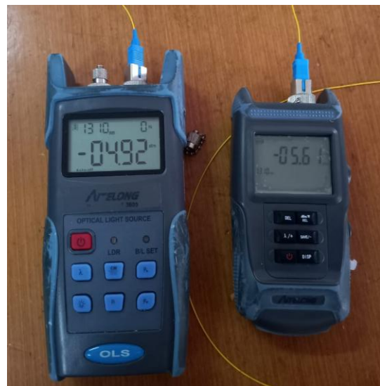
Gambar 8. Pengukuran Patch Cord Dengan OLS dan OPM Percobaan 1.
