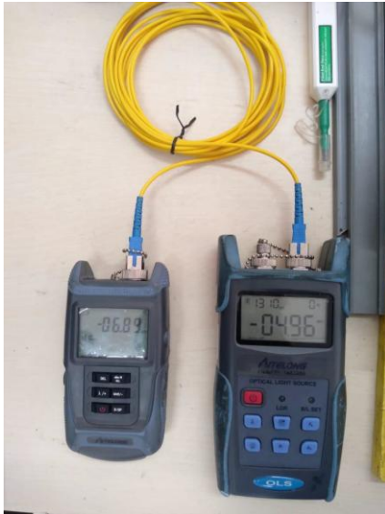
Gambar 9. Pengukuran Patch Cord Dengan OLS dan OPM Percobaan 2.
