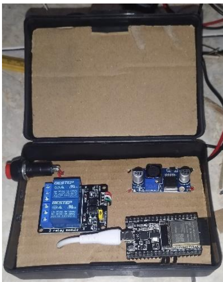
Gambar 9. Rangkaian Push Button dan Relay
