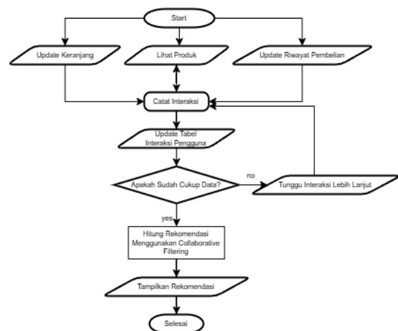
Gambar 2. Flowchart pengambilan data interaksi pengguna
